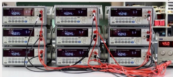
Figure 1 – Plusieurs voltmètres de la même référence branchés en parallèle sur une source de tension. Ils n'affichent pas la même valeur, mettant en évidence la variabilité cachée de la mesure d'une tension à l'aide d'un voltmètre unique.
